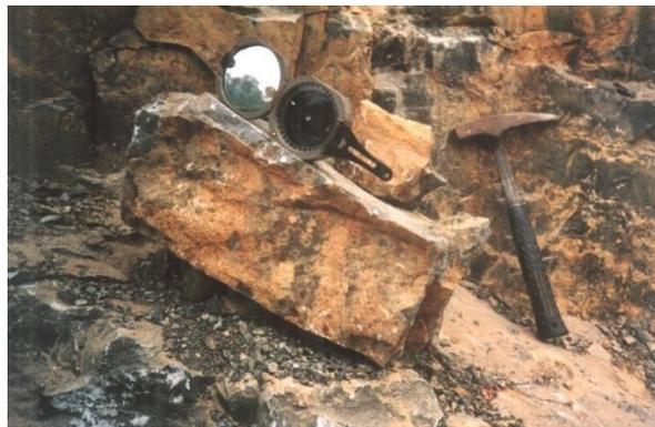
Ensayo 'Tilt Test' en las juntas del talud de la zona central
